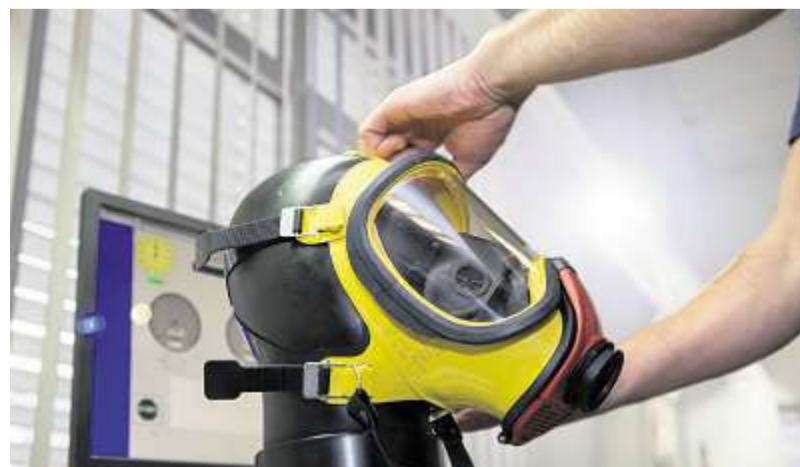
Mit der Prüfung, Reparatur oder Überholung von Masken und Atemluftflaschen sichern die Atemschutz-Mitarbeiter deren zuverlässige Funktion.
