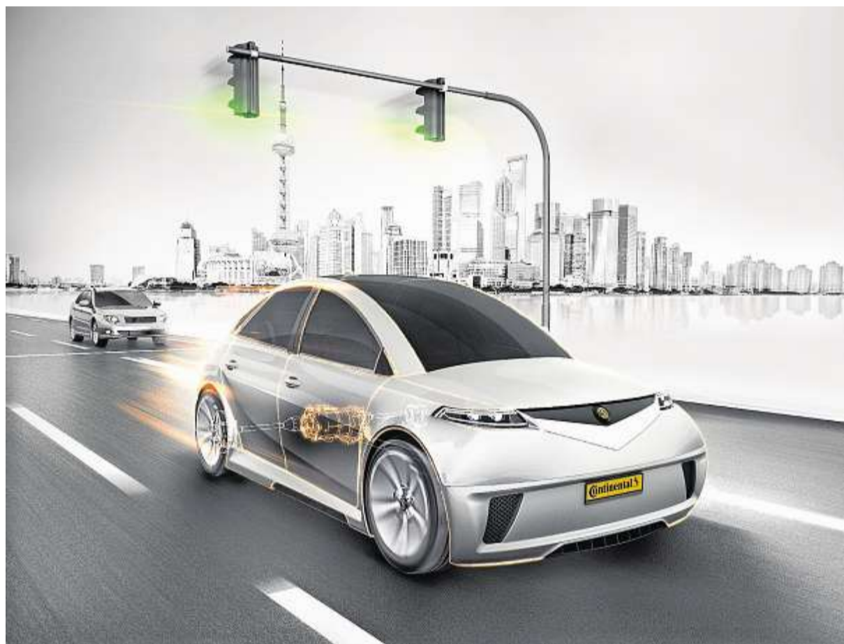
Die hochintegrierte E-Maschine umfasst Leistungselektronik, Getriebe und Elektromotor in einem und feiert 2019 Marktpremiere.
